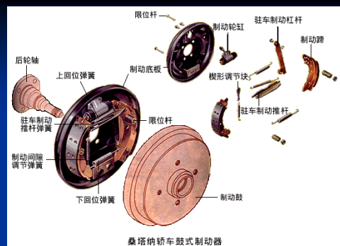
桑塔纳轿车鼓式制动器
