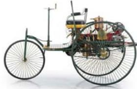
1885年德国人本茨研制的单缸四冲程汽油机装在一辆三轮车上，是近代车的原形
